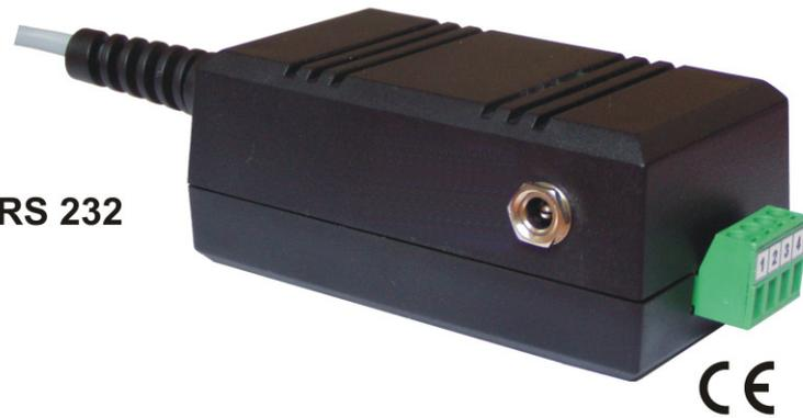
Der Konverter PMT-2/4-Z45 ermöglicht den Anschluss von SLAVE-Geräten mit RS 485 – Schnittstelle an MASTER-Geräte mit einer RS 232 – Schnittstelle (z.B.: PC). Das Gerät verfügt über eine galvanische Trennung zwischen der RS 232 - und der RS 485 – Schnittstelle. Der Konverter arbeitet mit allen BD|SIMEX – Geräten zusammen, welche mit einer RS 485 – Schnittstelle ausgerüstet sind.
