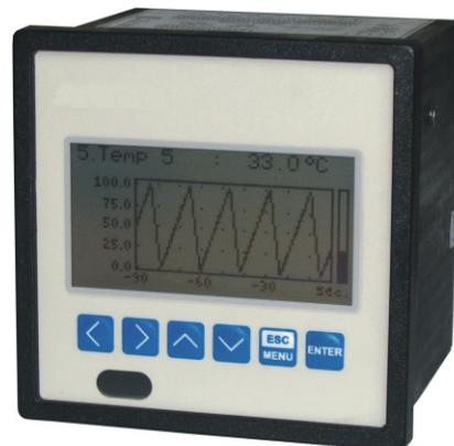
Die Prozessanzeige PAD-99T bietet in einem Fronttafelgehäuse 96x96mm ein großes grafikfähiges LC-Display. Die Bezeichnungen aller Kanäle und Einheiten kann frei als Text definiert werden. In jeder der Anzeigemodi sind Datum, Uhrzeit, Kanalbenennung, Einheit und der skalierte sowie der normierte Messwert dargestellt. Die Transmitterspeisung ermöglicht die Versorgung von angeschlossenen Messumformern. Durch die Schnittstelle RS-485 kann das Gerät mit dem Prozessleitsystem verbunden werden.
