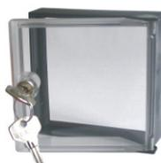
Verschließbare Tür mit Klarsichtscheibe für BD SIMEX-Geräte mit Fronttafelgehäuse 96x96mm mit Rahmen nach DIN 43700. Der Frontrahmen des Gerätes kann einfach durch den Türrahmen ausgetauscht werden und gewährleistet somit den Schutz vor Fremdzugriff und Beschädigungen des Displays.
