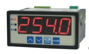
Die Prozessanzeige PAD-94D wurde für die Darstellung von Daten(Zahlen und Buchstaben) entwickelt, die sie über die Schnittstelle RS-485 von einem anderen Gerät empfängt. Sie bietet zwei Display-Varianten: ein 4-stelliges LED-Display mit einer Ziffernhöhe von 20mm oder ein 6-stelliges LED-Display mit einer Ziffernhöhe von 13mm.
