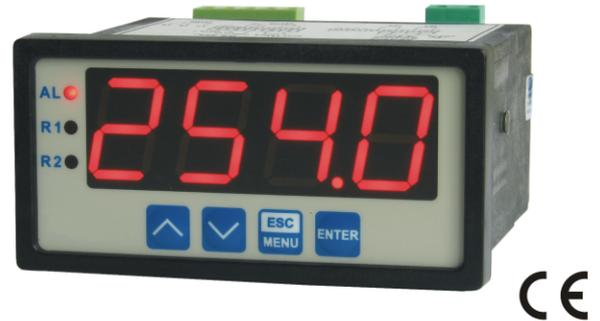
Die Prozessanzeige PAC-94T bietet in einem Fronttafelgehäuse 96x48mm ein großes 4-stelliges LED-Display mit einer Ziffernhöhe von 20mm. Das Gerät wurde für Widerstandsthermometer Pt100/500/1000 sowie für Thermoelemente Typ K, S, J, T, N, R, B und E entwickelt. Die Transmitterspeisung ermöglicht die Versorgung von angeschlossenen Messumformern. Durch die Schnittstelle RS-485 kann das Gerät mit dem Prozessleitsystem verbunden werden.
